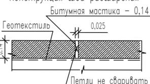
КОНСТРУКЦИЯ ВОДООТВОДНОГО ЛОТКА
